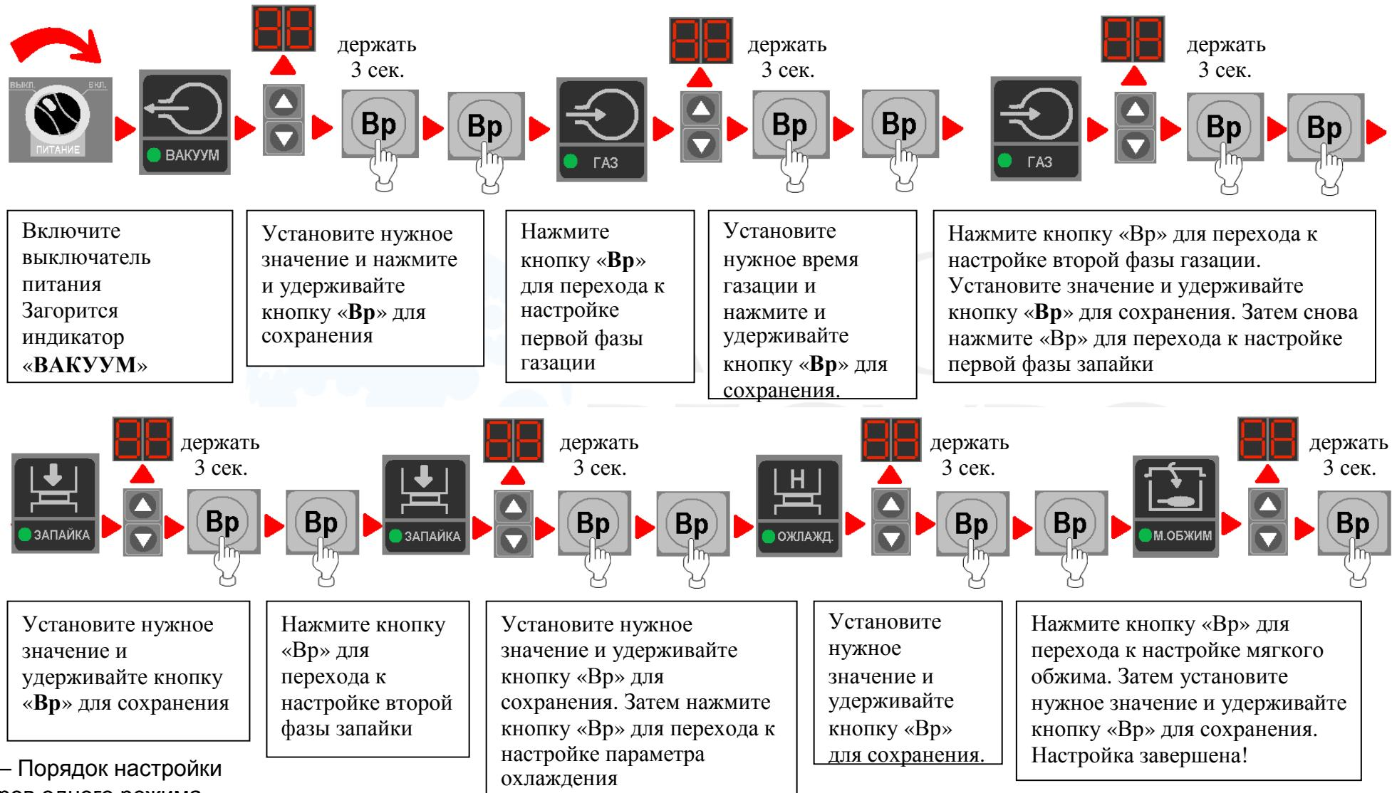
Рис. 2.6 – Порядок настройки параметров одного режима
