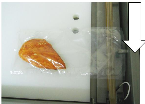
Рисунок 2.7 Укладка продукта при упаковке с использованием газации
